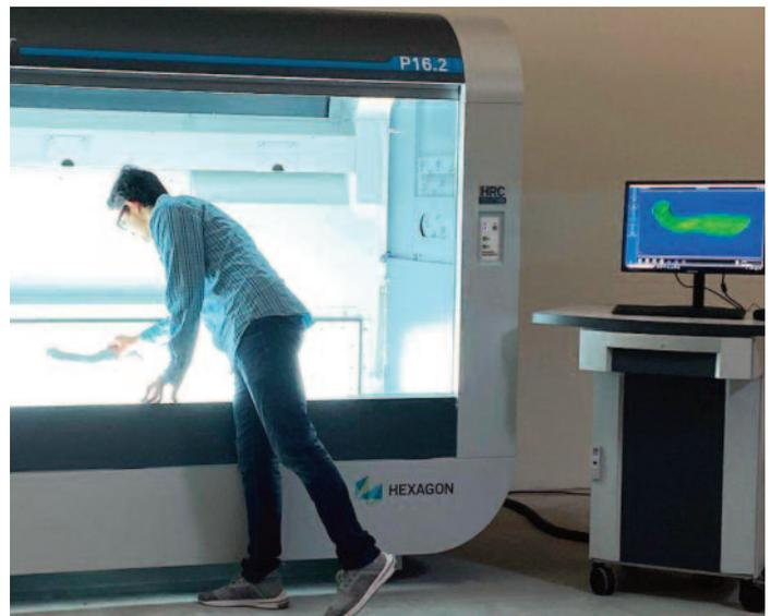
Die Messzelle ermöglicht digitale Highspeed-Vermessung von Musterrohren (Reverse Engineering) für höchste Präzision und maßgeschneiderte Ergebnisse.
